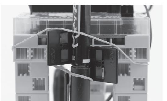
配線は、DCモーターの白いコネクターをM1からM2に変えるだけで、他は変更なし。M2にするのはケーブルの長さに余裕がないからだよ。電池ボックスのスイッチはOFFにすること。これで、ロボカーの改造は完了だ!
