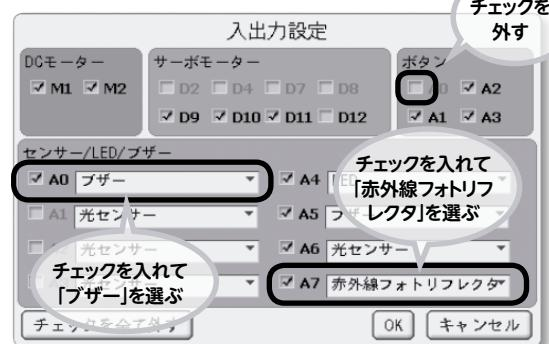
まず、「A7」を「赤外線フォトリフレクタ」に変える。次に、圧電スピーカーの設定だけど、圧電スピーカーを差し込んだ「AO」は、すでにスタディーノ本体のボタンで使われている。そこで、まず右上の「ボタン」にある「AO」のチェックを外してから、「センサー/LED/ブザー」にある「AO」にチェックをして、メニューから「ブザー」を選ぼう。終わったら「OK」ボタンで入出力設定を閉じよう。
