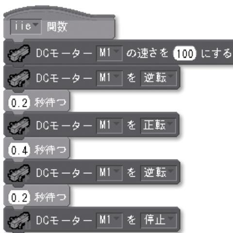
「iie▼関数」では、まずDCモーターが回る速度を「100」にしている。そして、「逆転」の向き（上から見て反時計回り）で0.2秒間回してから、「正転」の向き（上から見て時計回り）で0.4秒間回し、再び「逆転」で0.2秒回している。つまり、向かって右に首を振ってから、左に振り、最後に元の位置に戻るという動きになっている。
