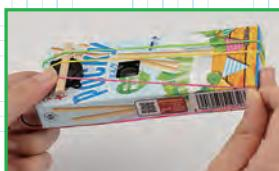
圧電サウンダーをケースの上部に両面テープで貼り付けたら、割り箸とケースをかけ渡すようにして輪ゴムの弦を1本～数本かける。
