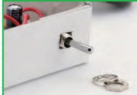
電源スイッチはケースに穴をあけて外部に出し、外側からネジ止めする。
