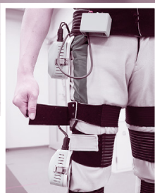
パンツタイプなら、装着にかかる時間は約3分! 最初にモーターの位置合わせを行えば、次からははくだけで装着が完了する。
